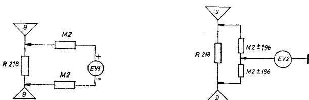
Obr. 9a. Pripojenie EV pri ladení ZMF Obr. 9b. Pripojenie EV pri ladení PD
